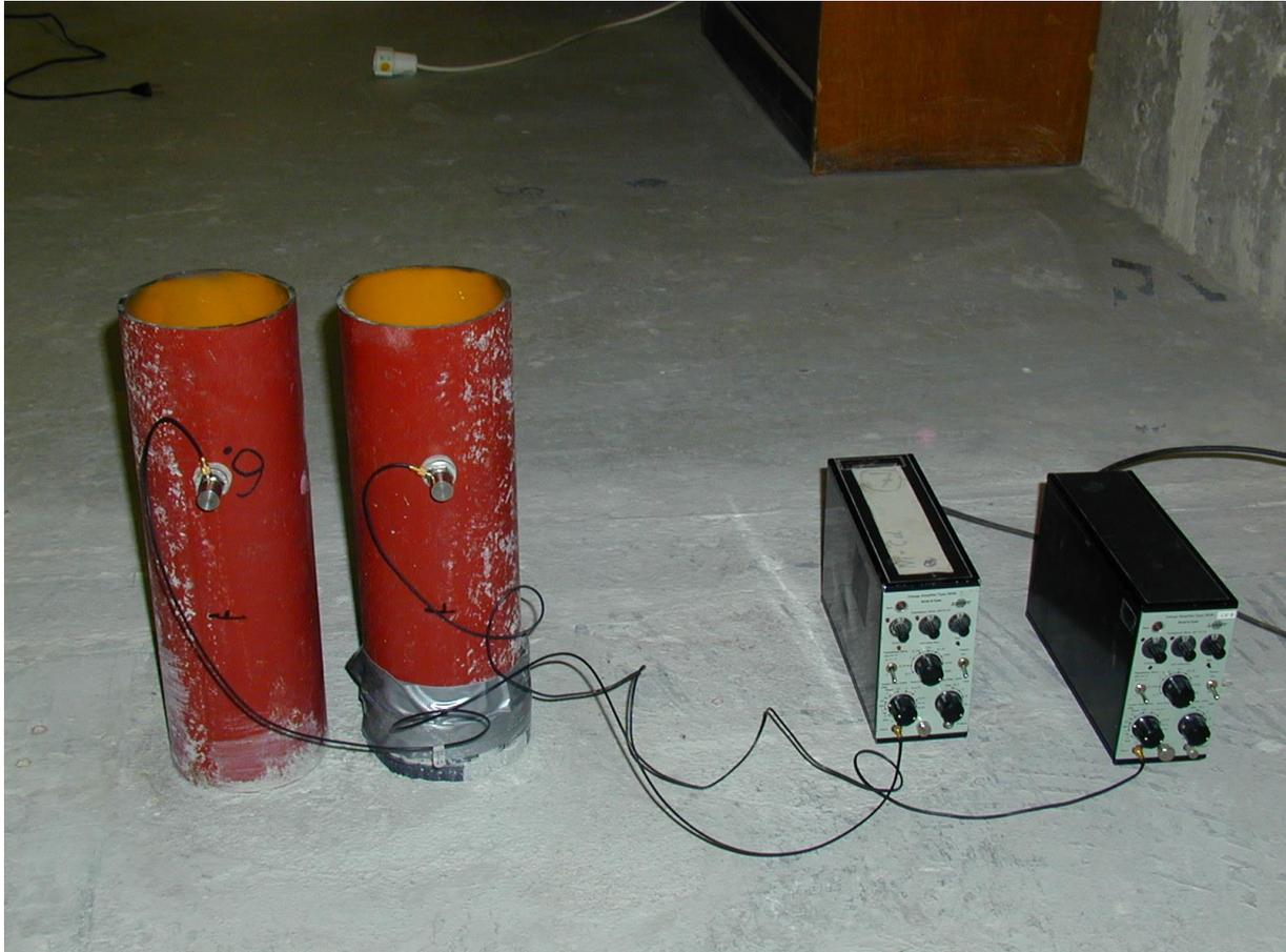
**Bild 1** Versuchsaufbau zur Messung der schallentkoppelnden Wirkung des Dämmschichtbildnermaterial (DSB) "Intumeszierender Streifen" Zulassungsnummer ETA-18/1019 der Firma Adolf Würth. Rohr 1 (links) ohne Ummantelung und Rohr 2 (rechts) umwickelt mit dem "Intumeszierenden Streifen".
